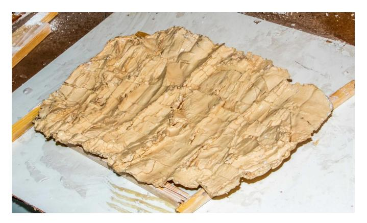
Schätze Sie ab, wie viel Wasser/Masse in etwa in der Form Platz hat und füllen Sie eine dementsprechende Menge Wasser in ein Behältnis. Geben Sie unter ständigem Umrühren, idealerweise mit einem Schwingbesen, von dem Gipspulver zu, bis Sie eine cremige, immer noch flüssige Konsistenz erhalten, welche noch gut in die Form gegossen werden kann.
