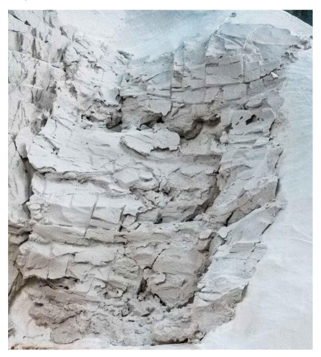
Die Masse ist bereits so weit erhärtet, dass sie sich nicht mehr richtig mit dem Untergrund verbindet. Beim Entfernen der Form lösen sich Teile des Gipses wieder und zerbröckeln.
